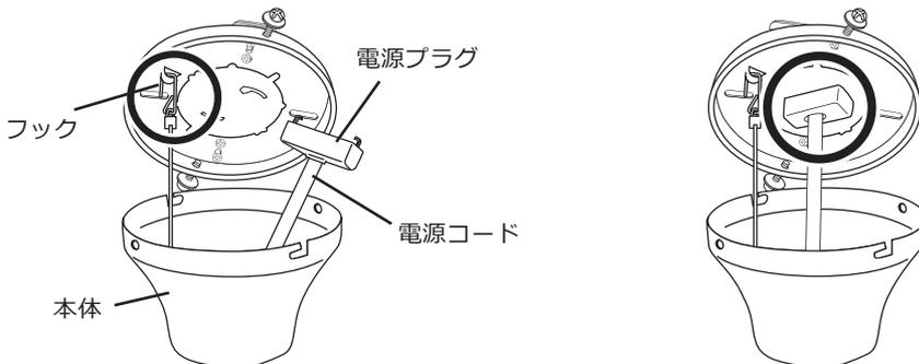
3. 取付金具に仮止めしてあるネジに本体を引っ掛け、下図のように本体を回転させて、はめこみます。
