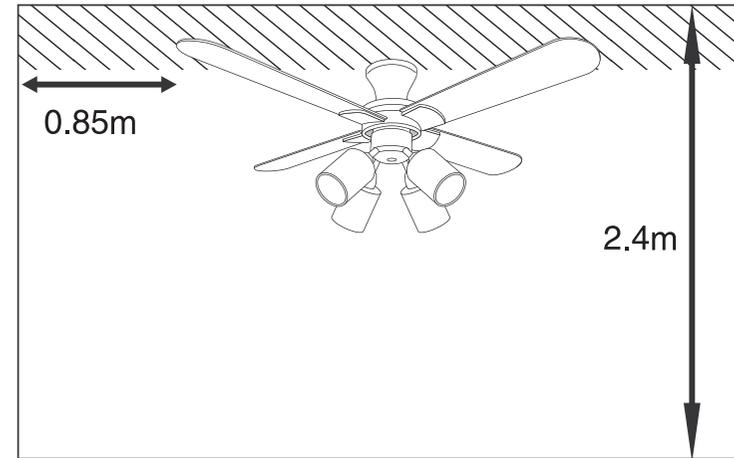
取り付けの際には上図の通りに必ず壁面から0.85m以上離すことができ、取り付けするお部屋の高さが2.4m以上であることをご確認ください。
