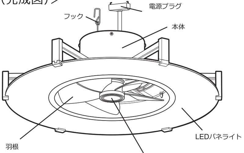
羽根固定スピナー・羽根固定クリップ(本体装着済)
