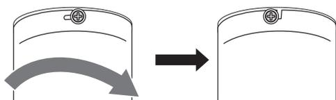
4. 残りのネジを仮止めしてから全てのネジを締め、固定します。
