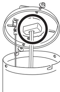
3. 取付金具に仮止めしてあるネジに本体を引っ掛け、下図のように本体を回転させて、はめこみます。
