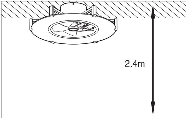
取り付けの際には上図の通りに取り付けするお部屋の高さが2.4m以上であることを必ずご確認ください。
