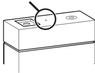
本体上部の穴はタンク内の空気抜き用の穴です。本体の取り外し、取り付けの際は触れないようにして確実に締めこんでください。
