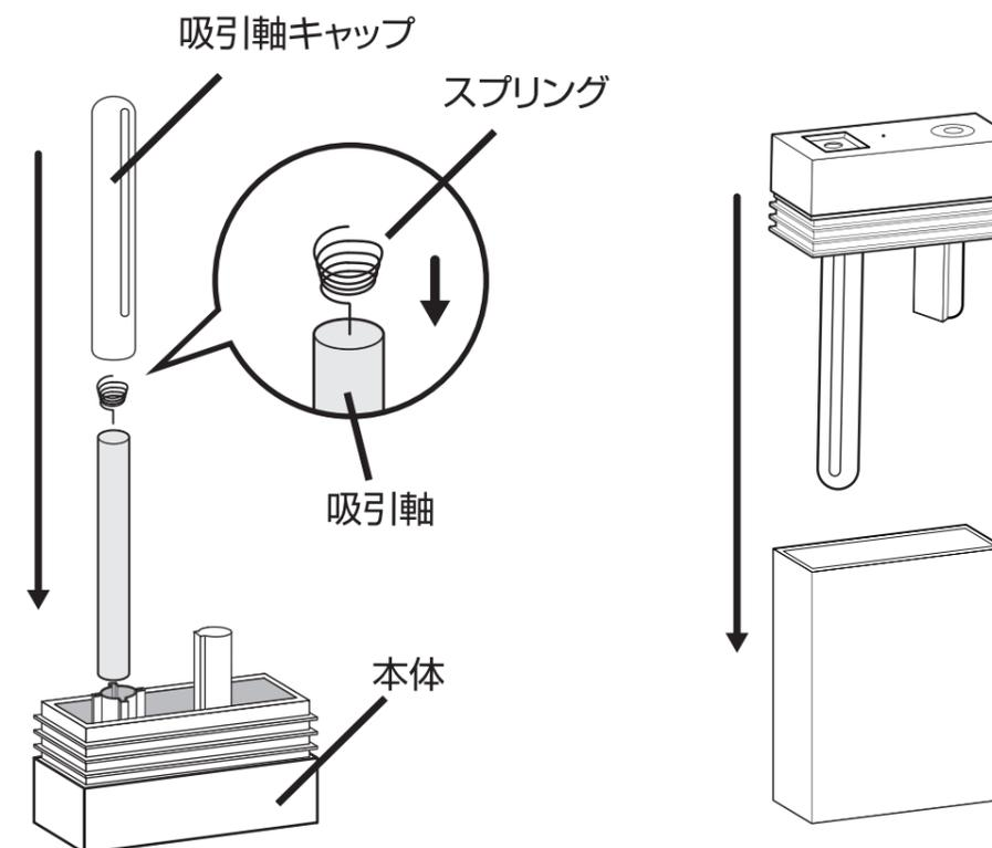
③図のようにスプリングを吸引軸に挿してから、吸引軸と吸引軸キャップを
