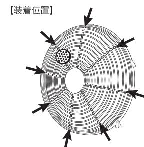
前ガードの、縦線(上図の矢印のライン)にフックを引っ掛けるようにしてセットしてください。
