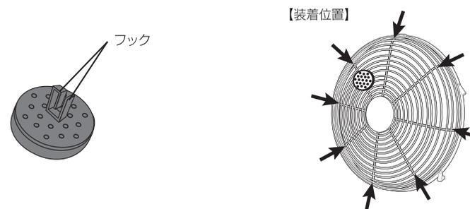
前ガードの、縦線(上図の矢印のライン)にフックを引っ掛けるようにしてセットしてください。
