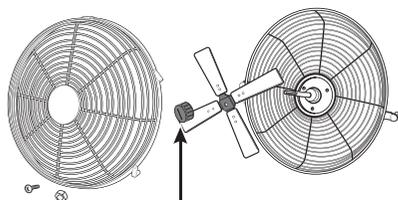
羽根を止めているネジは逆ネジになっています。ゆるめる場合は時計回りに回してください。
