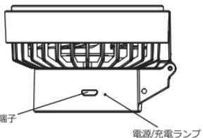
2.電源/風量切替スイッチをダブルクリックすると弱の風量で稼動し、電源/充電ランプが白色に点灯します。
