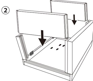
溝をかみ合わせながら、本体に側面パネルをセットしてください(2枚)。
